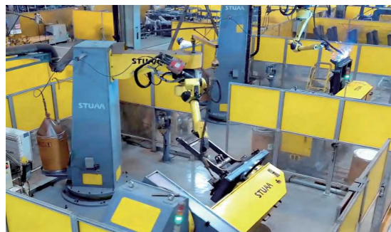
结构件焊接加工
